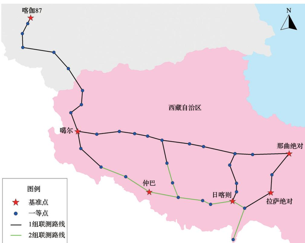
图 2 陆态网络西藏测区重力网 2020 年联测图
